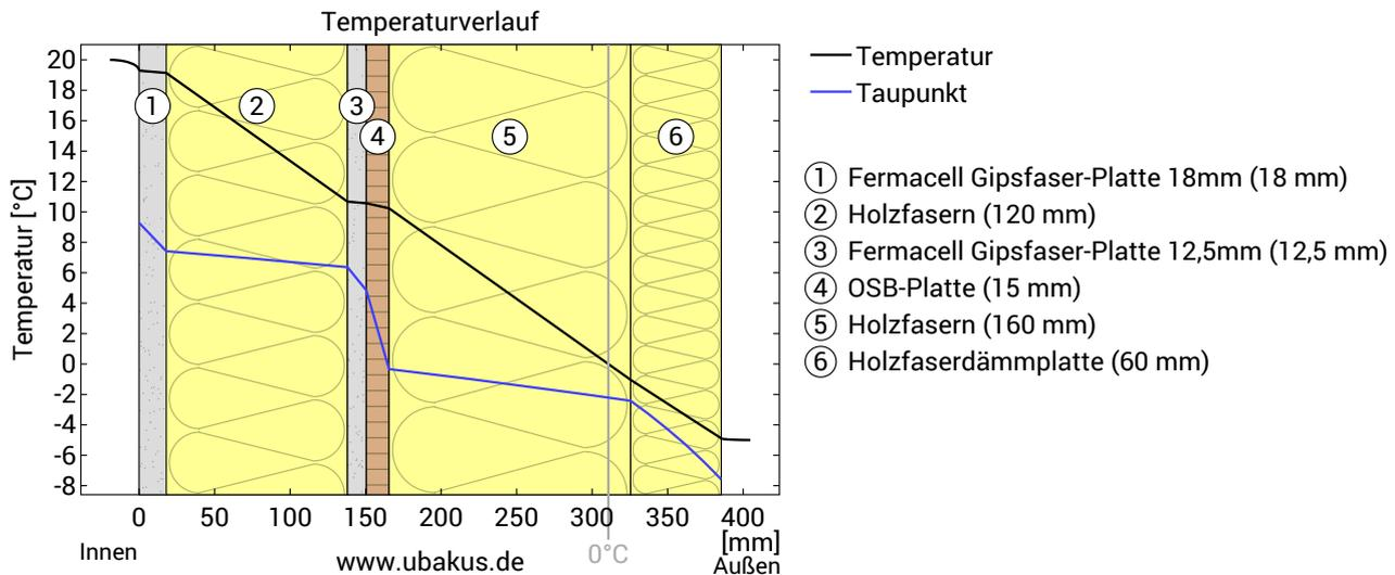
Verlauf von Temperatur und Taupunkt innerhalb des Bauteils. Der Taupunkt kennzeichnet die Temperatur, bei der Wasserdampf kondensieren und Tauwasser entstehen würde. Solange die Temperatur des Bauteils an jeder Stelle über der Taupunkttemperatur liegt, entsteht kein Tauwasser. Falls sich die beiden Kurven berühren, fällt an den Berührungspunkten Tauwasser aus.
