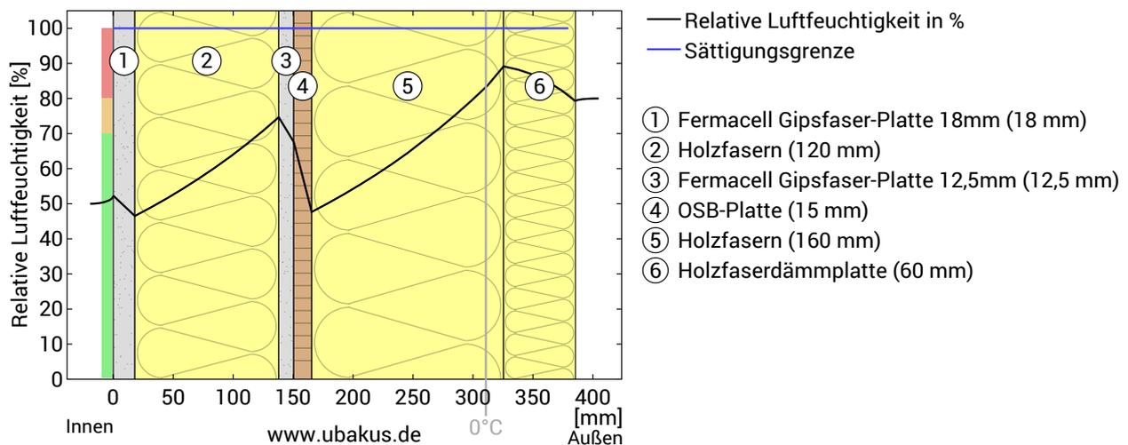
Hinweise: Berechnung mittels Ubakus 2D-FE Verfahren. Konvektion und die Kapillarität der Baustoffe wurden nicht berücksichtigt. Die Trocknungsdauer kann unter ungünstigen Bedingungen (Beschattung, feuchte/kühle Sommer) länger dauern als hier berechnet.
